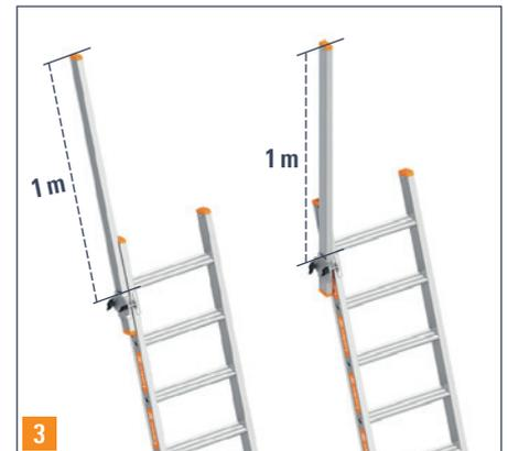
Im ersten Schritt ist zu entscheiden, auf welcher Seite und ob der Ausstiegsholm **1** im geraden Stellung (als Verlängerung) oder in einem Winkel von 70° zum Leiternholm angebracht werden soll. Je nach Anbringung muss die äußere Adapterplatte **3** in einem anderen Loch befestigt werden:
