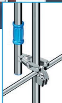
Anschluss des Montagepfostens an den Stellrahmen:
