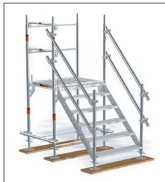
Mit der Layher Modultreppe werden stets passende, systemkonforme Aufstiege erstellt. Durch einfaches Zusammenstecken der einzelnen Treppenteile ist jedes Zwischenmaß mit einer Steigung von 20 cm erreichbar. Das Kopfelement wird in das U-Profil des Stellrahmens oder des Allround Riegels eingehängt. Unten nimmt das Endstück mit Gerüst-Spindeln die Feinnivellierung vor.
