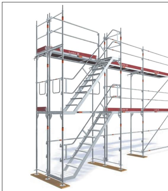
Der vorgestellte Podesttreppenturm ist in der Regelausführung (bis 24 m) in den Blitz-Zulassungen als Gerüstaufstieg enthalten, d. h. bei der geforderten Belastung von 1,0 kN/m<sup>2</sup> sind keine weiteren Nachweise erforderlich. Zulässige Belastung der Podesttreppe: 2,5 kN/m<sup>2</sup>. Zwischen Hauptbelag und Treppenpodest kommt ein 0,19 m breiter Serienboden (Stahl- oder Stalu-Boden) zum Einsatz. Dieser lagert mit einer Kralle in der Distanzkupplung.
