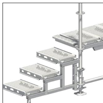
Ein Geländeausgleich mit Aufstieg zur ersten Gerüstlage kann mit der Allround Modultreppe realisiert werden. Der Baukasten besteht aus: Wange für Modultreppe 1-, 2- und 3-stufig, Anfangsstück für Modultreppe 0,26 m und O-Riegel LW 0,90 m. Als Stufen werden 0,32 m breite Standard Gerüstböden in der gewählten Länge eingebaut. Die Stufen werden mit Belagssicherungen befestigt.
