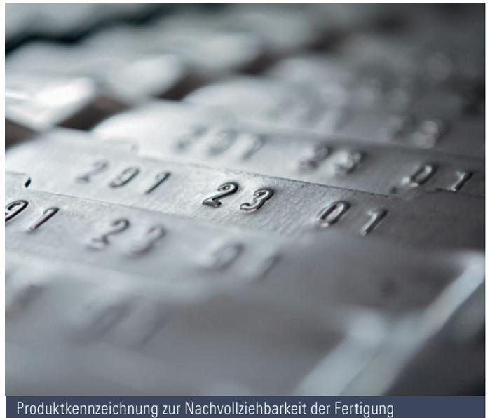
Produktkennzeichnung zur Nachvollziehbarkeit der Fertigung
