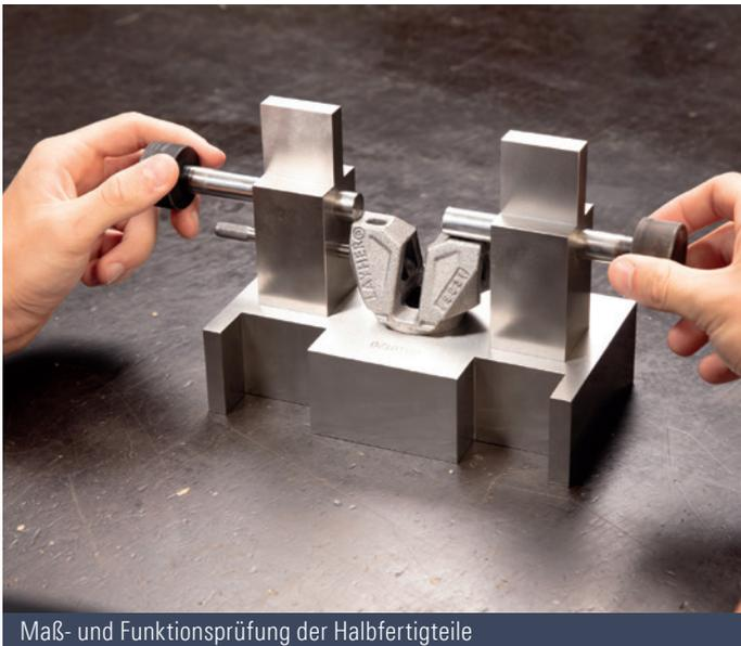
Maß- und Funktionsprüfung der Halbfertigteile
