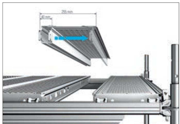
Stufenlos von 40 bis 255 mm verstellbarer teleskopierbarer Spaltboden
