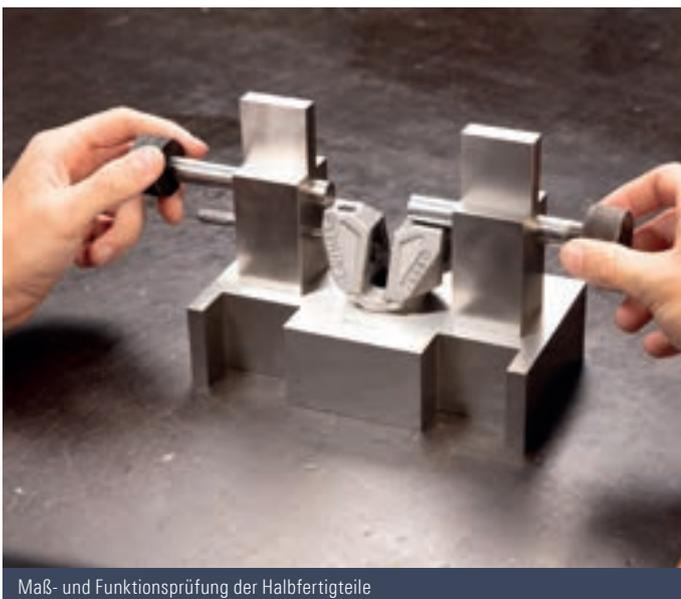
Maß- und Funktionsprüfung der Halbfertigteile
