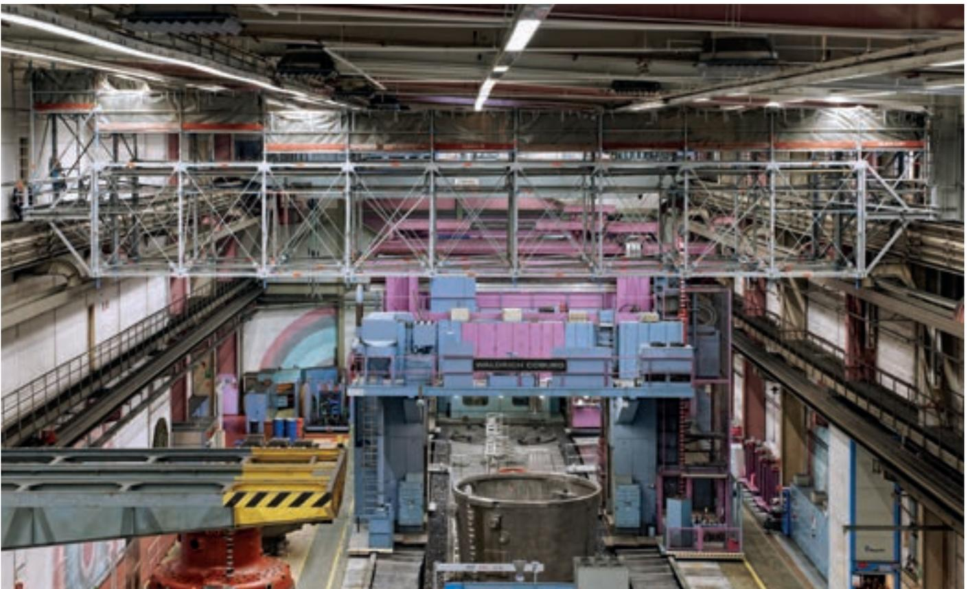
Verfahrbare Arbeitsplattform an einer Hallendecke – die Bodenfläche bleibt frei, wodurch der Betrieb fortgesetzt werden kann. Die Verfahrbarkeit verringert den Materialeinsatz.
