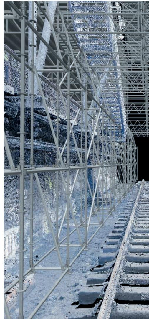
*In die Punktwolke kann mithilfe von LayPLAN CAD aus der LayPLAN SUITE das Gerüst optimal eingeplant werden.*
