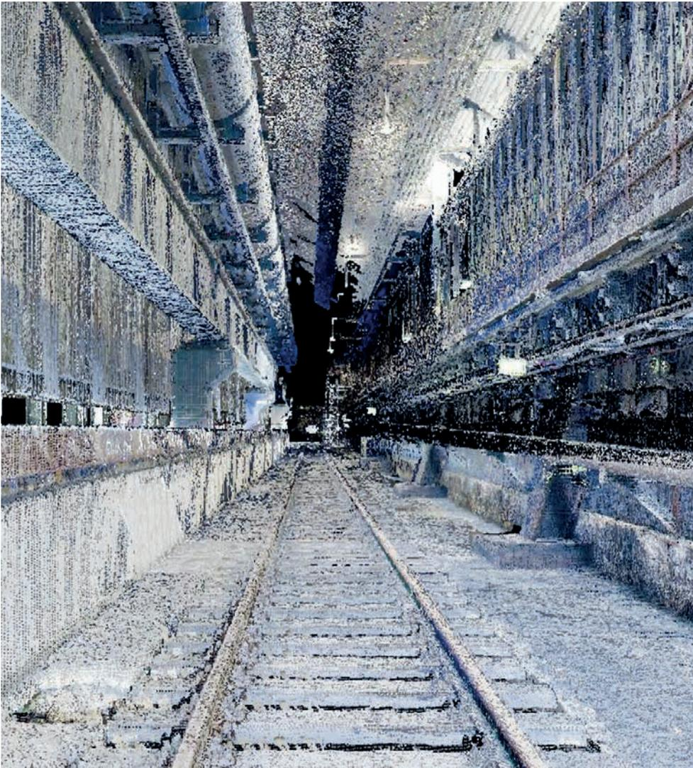
*Das Ergebnis des Scans ist eine 3D-Punktwolke, die jedes Detail im Raum abbildet.*
