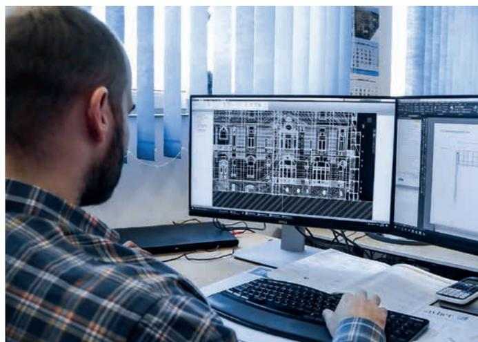
*Gerüstbau beginnt am Computer. Auf Basis von 3D-Daten wurde die Villa mithilfe von Layher SIM® (Scaffolding Information Modeling) mit den Software-Modulen der LayPLAN SUITE komplett eingerüstet und mit einem Wetterschutz-Kederdach versehen.*
