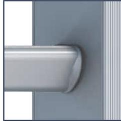
Die besondere Konstruktion des Leiternholmprofils ermöglicht hohe Belastungen bei geringem Leiternengewicht. Wulste entlang der äußeren Holmwand verhindern Beschädigungen an der Sprossenbördelung z. B. beim Gleiten über LKW-Ladekanten.
