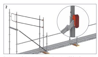
Einhängen der Geländer in den bereits aufgesteckten AGS-Stiel. Trotz geschlossenem Bügel kann das Geländer aus der gesicherten Lage montiert werden. Anschließend werden die Geländer mit dem nächsten AGS-Stiel verbunden.
