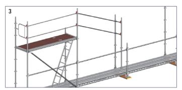
Nach oben schwenken, AGS-Stiel aufstecken, U-Riegel einbauen und Boden einhängen. In gleicher Art und Weise kann das gesamte Fassadengerüst sicher montiert werden. Die Demontage erfolgt in umgekehrter Reihenfolge.
