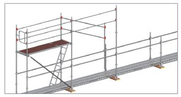
Der AGS-Stiel erlaubt sowohl eine vorlaufende Geländermontage nur an der Gerüstaußenseite als auch beidseitig. In diesem Fall wird auch an der Gerüstinnenseite zur Fassade hin, analog zur Gerüstaußenseite, mit einem 1-Meter-Stiel begonnen. Die weitere Montage erfolgt identisch zur Aufbauvariante 1.
