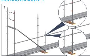
Der Aufbau beginnt an der Gerüstaußenseite mit 1-Meter-Stielen. Aufstecken des ersten AGS-Stiels mit vormontiertem Stirngeländer. Montage eines U-Riegels und einer Allround Diagonale. Alternativ zum Anfangsstück und dem 1-Meter-Stiel kann der AGS-Anfangsstiel LW oder der Allround Stiel LW 1,16 m mit 3 Lochscheiben (siehe Detailbilder) verwendet werden.
