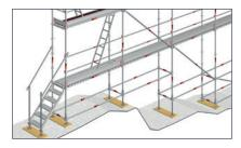
Da das modulare Fassadengerüstsystem AGS komplett in den AllroundGerüst-Baukasten integriert ist, erfolgt eine Geländeanpassung schnell und einfach durch den Einsatz von Allround Serienbauteilen.
