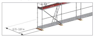
Wenn z.B. für Bewehrungsarbeiten größere Arbeitsflächen notwendig sind, kann durch den Einsatz von Standard U- oder O-Riegeln die Gerüstbreite bis zu 3,07 m frei gewählt werden.
