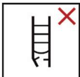
Leiter nach Lieferung prüfen. Vor jeder Nutzung Leiter auf Beschädigung und sichere Benutzung sichtbar prüfen. Keine beschädigten Leitern benutzen.
