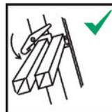
Sperreinrichtungen müssen vor der Benutzung vollständig gesichert werden, wenn dies nicht automatisch erfolgt.
