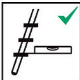
Anlegeleitern mit Stufen müssen so verwendet werden, dass sich die Stufen in horizontaler Lage befinden.
