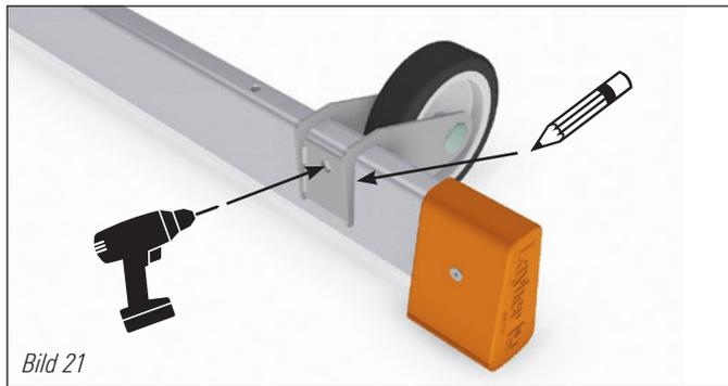
3. Traversenrolle horizontal um 180° drehen und an der Markierung ausrichten und ebenfalls durch das Loch in der Halterung bohren.
