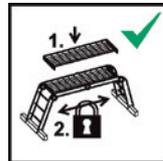
Bei einer Verwendung der Leiter als Plattform dürfen nur vom Hersteller empfohlene Plattformelemente verwendet werden. Das Plattformelement muss vor der Benutzung gesichert werden.
