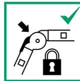
Die Einrastbolzen an den Scharnierblechen müssen vor der Benutzung auf beiden Seiten eingerastet und somit gesichert sein.
