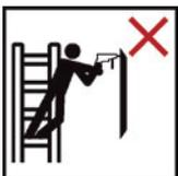
Arbeiten, die eine seitliche Belastung bei Leitern bewirken, z. B. seitliches Bohren durch feste Werkstoffe, vermeiden.
