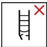
Leiter nach Lieferung prüfen. Vor jeder Nutzung Leiter auf Beschädigung und sichere Benutzung sichtbar prüfen. Keine beschädigten Leitern benutzen.
