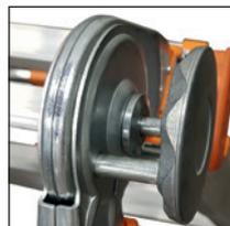
Bild 12: Entsperrtes Gelenk
