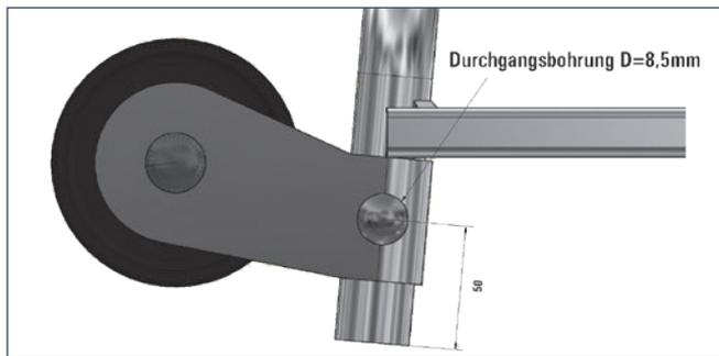
1. Setzen Sie eine Durchgangsbohrung an den beiden hinteren gekennzeichneten Enden des Maschinentrittes.
