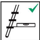
Anlegeleitern mit Stufen müssen so verwendet werden, dass sich die Stufen in horizontale Lage befinden.
