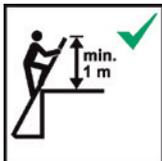
Leitern für den Zugang zu einer größeren Höhe müssen mindestens 1 m über den Anlegepunkt hinaus ausgeschoben und bei Bedarf gesichert werden.
