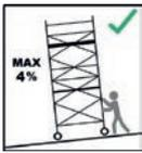
Das Verfahren ist nur auf ausreichend tragfähigem Untergrund mit einer max. Neigung von 4% (ca. 2,5°), in Längsrichtung oder über Eck gestattet und darf die normale Schrittgeschwindigkeit (4 km/h) nicht überschreiten. Jeglicher Anprall ist zu vermeiden.
