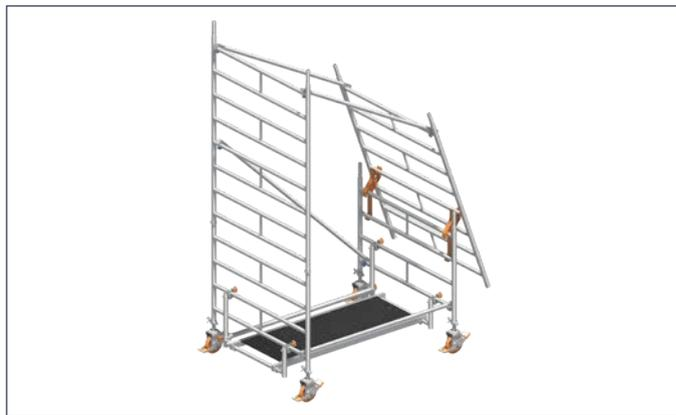
1. Die Lenkrollen **1** in die Standleitern 1 m **4** einstecken und mit Flügelschrauben gegen herausfallen sichern.
