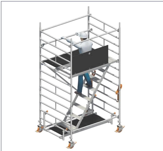
13. Aufstieg über die Stufen der Podesttreppe **8** durch die dafür vorgesehene Durchstiegsklappe. In der Durchstiegsöffnung, auf der Treppe stehend, absturzgesichert durch die Holme der Treppendurchstiegsbrücke **10**, erfolgt die Montage der Zwischengeländer der nächsten Lage, hierzu werden die Geländer **5** jeweils an den zweiten Sprossen über der Standfläche montiert.
