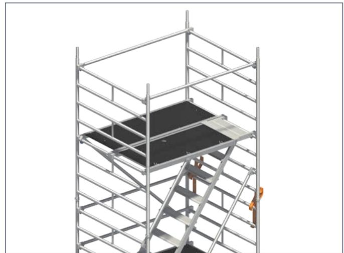
8. Ummontieren der temporär montierten Treppendurchstiegsbrücke. Ausbau aus der Position der unteren Podesttreppe 8 durch öffnen der Einrastklauen und Aushängen aus dem vorderen Bereich des Treppenpodests und direkte Montage im selben Bereich der nächsten Podesttreppe 8.
