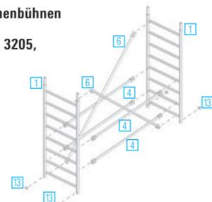
Die Zwischenetage wird durch Aufstecken von 2 Standleitern **1** und dem Einrasten von 2 Diagonalen **6** aufgebaut. Die Standleitern **1** sind durch das Einstecken von Federsteckern **13** zu sichern. Über Belagebenen werden bei den Gerüsttypen 3205, 3206 und 3207 4 Rückenlehnen **4** in die 2. und 4. Sprosse von unten der Standleitern **1** eingebaut. Alle Diagonalen **6** und Rückenlehnen **4** sind beim Aufbau soweit wie möglich nach außen zu schieben.
