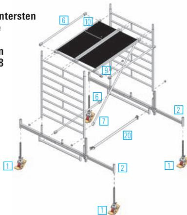
1. Die Lenkrollen **1** in den Fahrbalken **2** einstecken und durch Festdrehen der Flügelschrauben an den Spindelmuttern gegen Herausfallen sichern.
