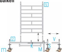
Der verstellbare Fahrballen **2** ermöglicht das Arbeiten an der Wand. Er kann im aufgebauten Zustand ein- und ausgeschoben werden. Es ist zu beachten, dass vor dem Verstellen auf jeden Fall die in der Ballastierungstabelle angegebenen Ballastgewichte an der richtigen Stelle angebracht sind (siehe Seite 7). Zum Verstellen im aufgebauten Zustand wird die am Fahrballen **2** angebrachte Mittelstütze (M) soweit wie möglich abgelassen und gesichert.
