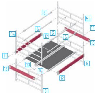
Nach dem Aufstecken der obersten Standleitern **5** oder **5a** und Sichern mit Federsteckern **11** wird in die von oben 5. Sprosse eine Durchstiegbrücke **10** und eine Belagbrücke **9** eingehängt. Herstellen des vorschriftsmäßigen Seitenschutzes je nach Gerüsttyp durch den Einbau von 2 Doppelrückenlehnen **8** oder 4 Rückenlehnen **6** einstellen und durch Einfügen von 2 Stirnbordbrettern 1,44 m **13** sichern.
