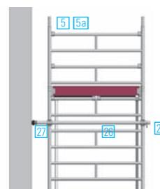
Für Arbeiten, die an einer tragfähigen Wand ausgeführt werden, kann die Ballastierung entsprechend der Tabelle Ballastierung (siehe Seite 7) reduziert werden.
