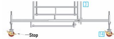
Maximaler Höhenausgleich (Spindelweg) ohne Belag an der Fußspindel = 15 cm
