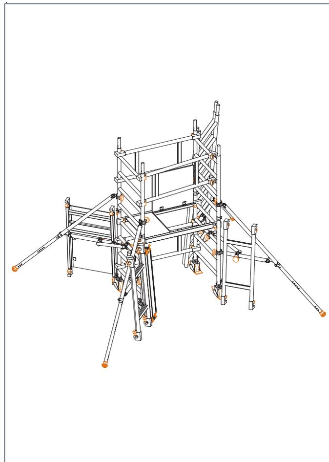
7. Die vorgesteckten Standleitern aus der unter Punkt 5 genannten „Pos. c“ in die dafür vorgesehenen Rohverbinder der bereits montierten Standleitern aufstecken und die Stöße mit Federsteckern **8** sichern.
