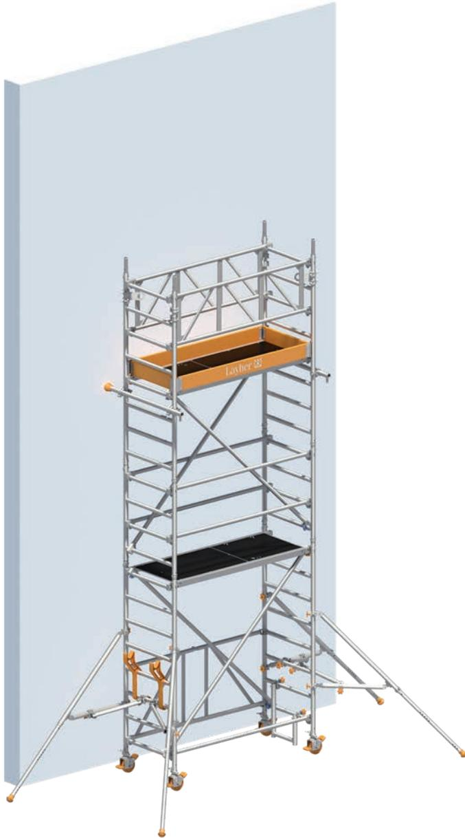
Für Arbeiten, die an einer tragfähigen Wand ausgeführt werden, kann die Ballastierung entsprechend der Tabelle **Ballastierung** (siehe Seite 17) reduziert werden. In diesem Fall sind auf beiden Seiten des Gerüsts Wandabstützungen oder Verankerungen einzubauen.
