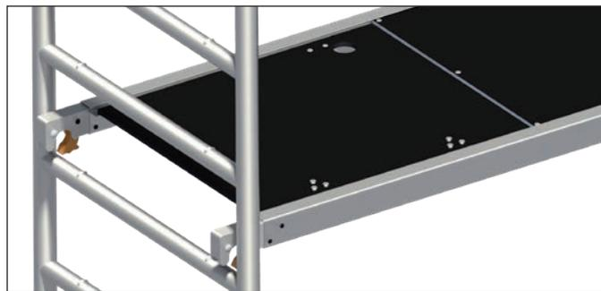
Die **orangenen** Schließbügel der Böden ermöglichen, durch ihre speziell dafür gestaltete Geometrie, den mühelosen Ein- und Ausbau durch eine Person; sie sind zuerst zu lösen und der Belag mit den geöffneten Bügeln auf die Sprosse aufzulegen, dann erst werden die gegenüberliegenden Bügel gelöst und der Belag kann ausgehoben werden.
