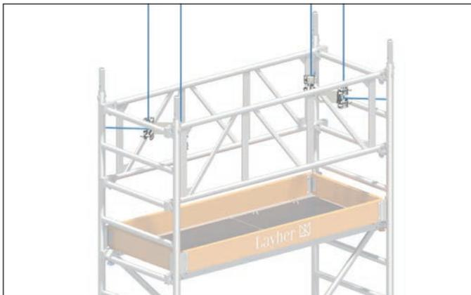
2. Beide Kupplungen an der oben genannten Position am Holmrohr anlegen und die Kupplungsdeckel durch einhängen der Schrauben schließen.
