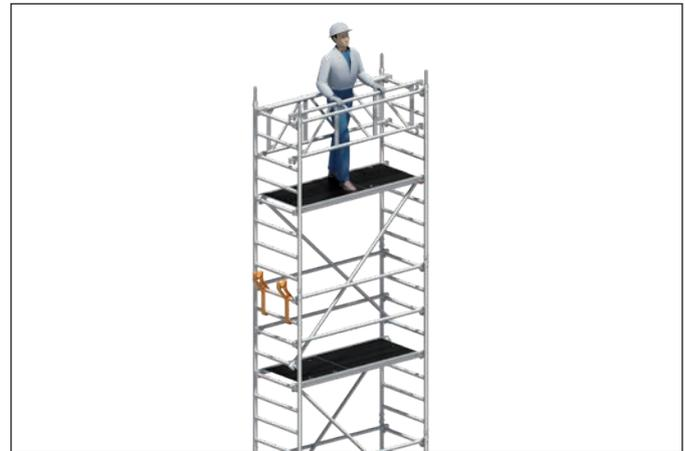
6. Auf die nächste Ebene aufsteigen und die für die Steifigkeit beim Kranversatz erforderlichen Träger 10 montieren. Dabei werden die für den Sicherheitsaufbau erforderlichen Geländer 9 wieder demontiert, diese können in einer der unteren Lagen oder im Fußbereich der Konstruktion montiert/deponiert werden.
