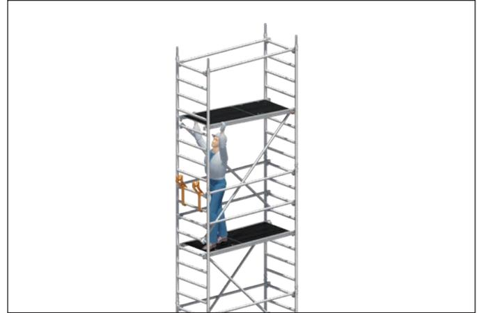
5. Diagonalen 12 und Durchstiegsbrücke 13 einsetzen. Die Diagonalen müssen auf beiden Seiten turmartig (Zickzackform) eingebaut werden.
