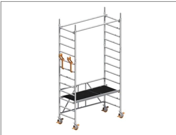
6. Hängeleiter 75/4 7 mit Geländer nach oben schwenken, in die dafür vorgesehenen Rohverbinder der Falteinheit 75/8 6, aufstecken und mit Rohrklappstecker 20 sichern.
