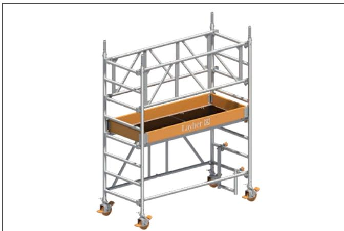
1. Die Lenkrollen 1 in die Falteinheit 75/8 6 einstecken und mit den dafür vorgesehenen Schrauben an den Feststellern der Spindelmutter gegen Herausfallen sichern.
